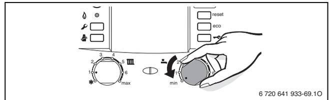
Fig. 63 Frost protection for the DHW tank
